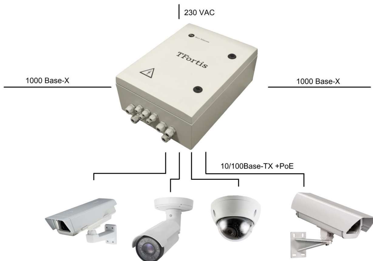
Рисунок 1 - Схема подключения PSW-2G4F-Box
